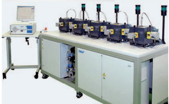
SKF ROF+ Fettprüfmaschine
