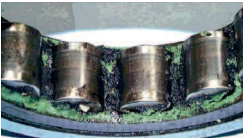
Verschmutzter Schmierstoff durch Funkenerosion
