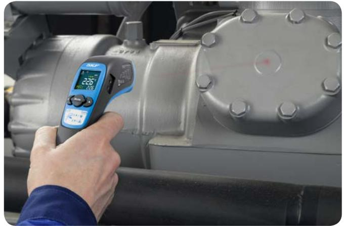
Im kontaktlosen Modus misst das SKF Infrarot-Thermometer die Temperatur eines Objekts. Direkt auf ein Objekt gerichtet, sammelt das SKF Infrarot-Thermometer Temperaturdaten und erzeugt ein Signal, das der Mikroprozessor verarbeitet und auf dem hintergrundbeleuchteten Display anzeigt. Ist der Auslöser gedrückt, wird die Temperatur des Objekts fortlaufend durch das SKF Infrarot-Thermometer gemessen. Dies ermöglicht schnelle und genaue Messwerte in Echtzeit
